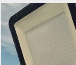
Água na parte interna do refletor
